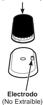
Ensamble de la Cabeza y de la Tapa del Quemador Oval (No Extraíble)
